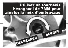
Ajustez l'embrayage en vous servant d'un tournevis hexagonal de 7 mm pour tourner la noix d'embrayage.
