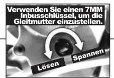
Stellen Sie die ein mit einem 7-mm-Inbusschlüssel einschieben die Gleitmutter zu drehen.
